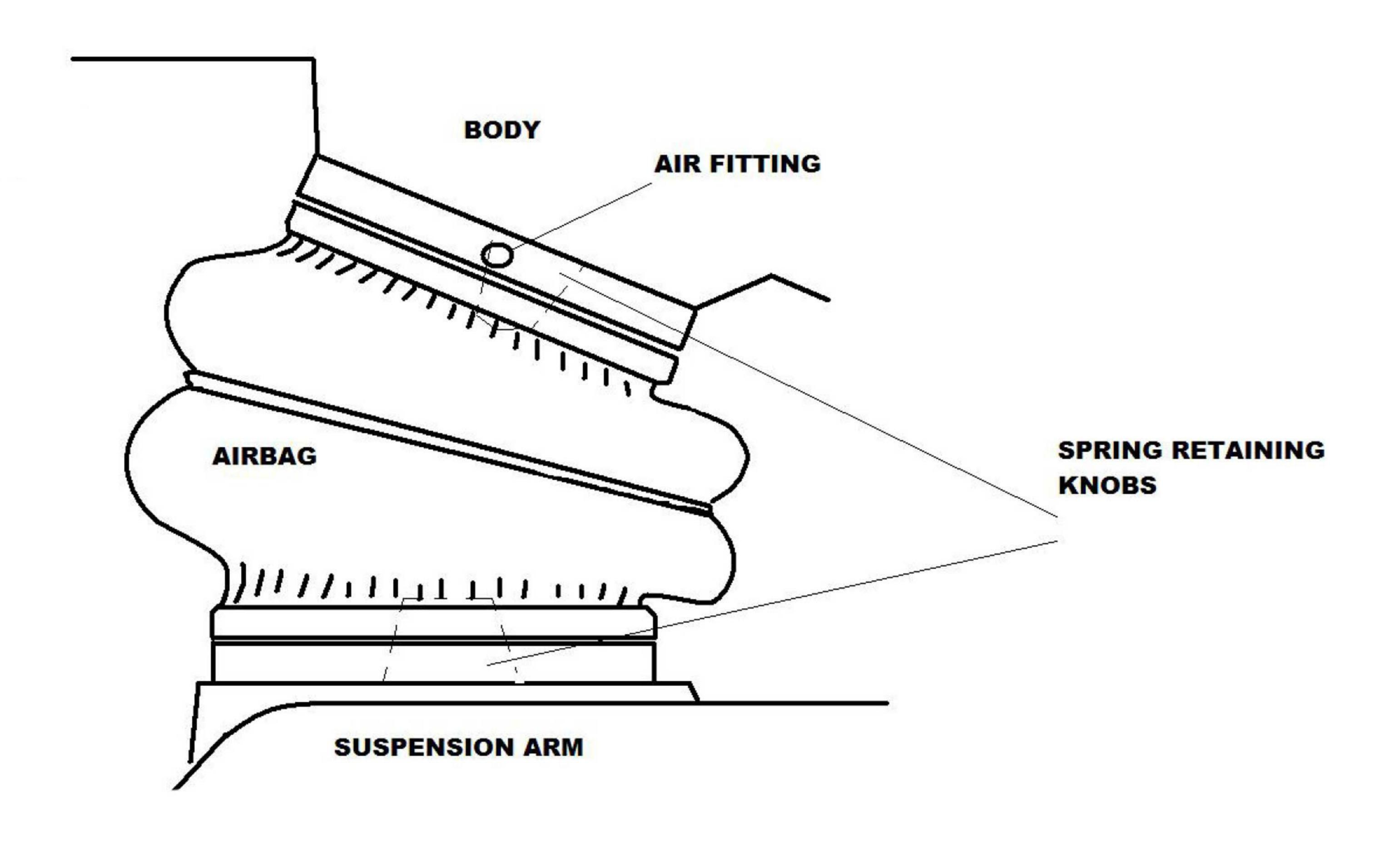
BE SURE TO POSITION THE BAGS SO THE BAG DOESNT RUB ON THE CHASSIS. THE LOCATION HOLES ARE OFF-SET FOR THIS REASON
